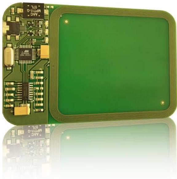
A utilização deste leitor/gravador é extremamente simples, basta aproximar um cartão, pastilha ou porta-chaves RFID para efectuar uma leitura ou gravação. Os dados são enviados para o PC utilizando o cabo USB, onde podem ser capturados pelo software fornecido ou por qualquer outra aplicação que utilize o módulo de desenvolvimento ActiveX existente.
