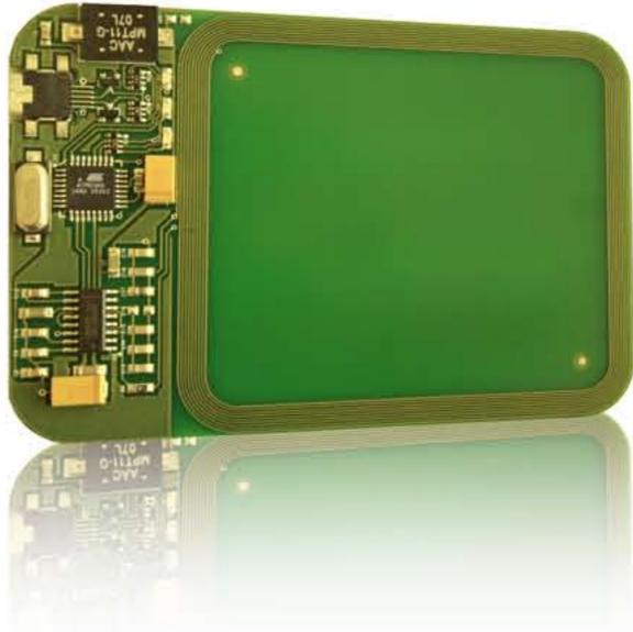
El uso de este lector / grabador es muy sencillo, basta aproximar una tarjeta RFID para realizar una lectura o grabación. Los datos se envían para el PC mediante un cable USB, que pueden ser capturado por el software suministrado o cualquier aplicación desarrollada por el cliente, simplemente utilizando el módulo de desarrollo ActiveX disponibles.
